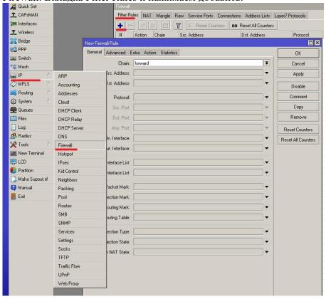
Запрещаем пинги на наше устройство, для этого, на вкладке general, chain выбираем input
