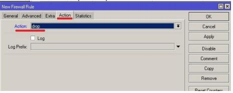
Запрещаем доступ к управлению маршрутизатора. Для начала создаем лист с нашими разрешенными адресами, переходим в IP-Firewall, вкладка Address Lists, добавляем новый лист
